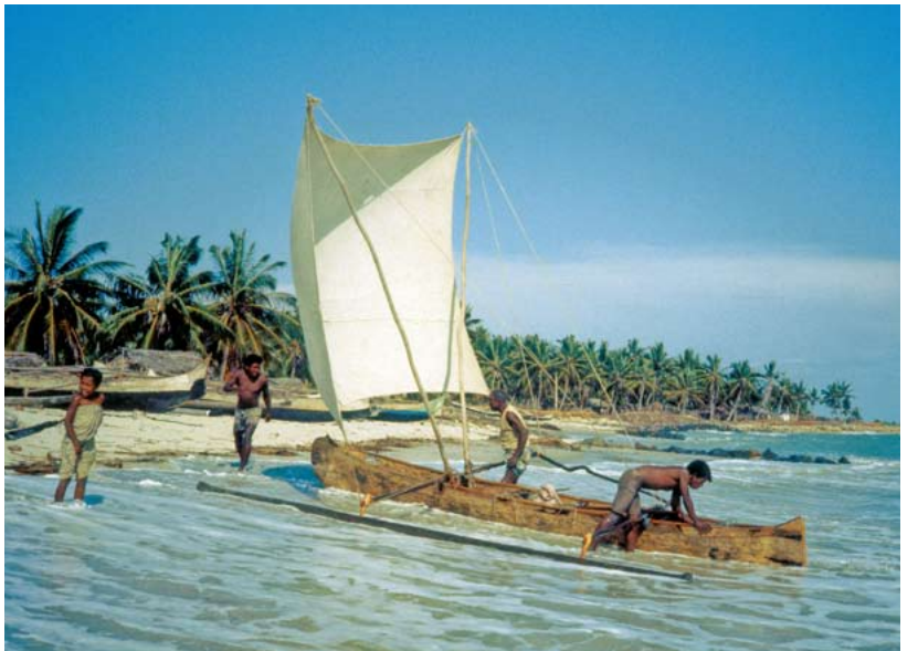
マダガスカル島の帆走アウトリガー・カヌー。転覆防止のためのウキが片側にしかないのは、よほど太い支柱で取り付けないと、大波などで片側が浮き上がったときにそちら側の支柱が折れてしまうからだ。（撮影：深澤秀夫）
