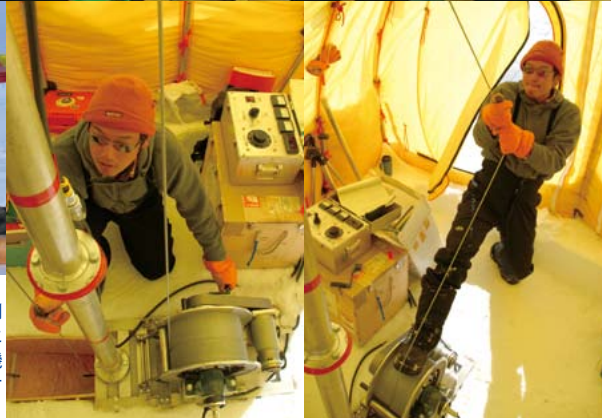
(左) 掘削中の様子。ワイヤーを握り掘削機から伝わる振動を感じながら、慎重にワイヤーを繰り出していく。(右) 掘削機に入ったアイスコアを氷河から切り離すため、体重をかけてワイヤーを引っ張る。
