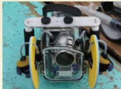
図4 右左の音を遮蔽板で振り分ける防水バック「ハナ」。「ナハナハッ!」とやっているかみえなくもない外観から、この愛称がついた。
